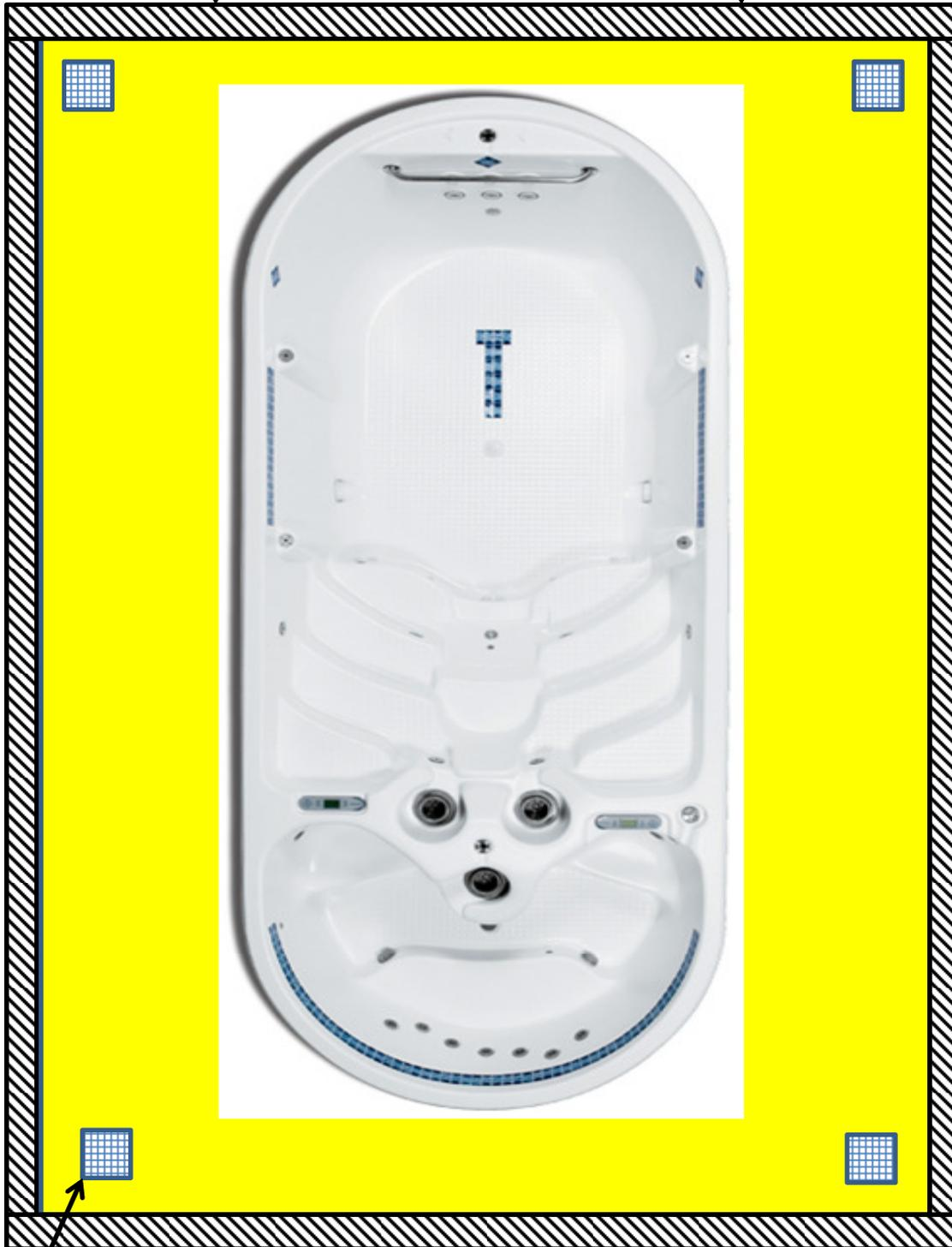
Mehrere Bodenablaufschacht im Revisionsbereich ist zwingend. (Wegen Überflutung)
